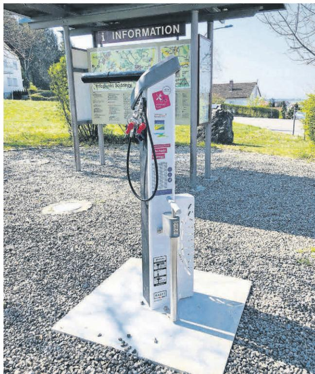
Am RadSERVICE-Punkt haben Radfahrende die Möglichkeit, einen kurzen Sicherheitscheck oder kleinere Reparaturen schnell und unkompliziert selbst durchzuführen. Die Station verfügt über eine Luftpumpe mit Manometer inklusive dualen Pumpkopf für alle gängigen Ventile. Insgesamt acht Werkzeuge an Haltekabeln und eine Fahrradaufhängung können unabhängig von Tag und Uhrzeit genutzt werden.
