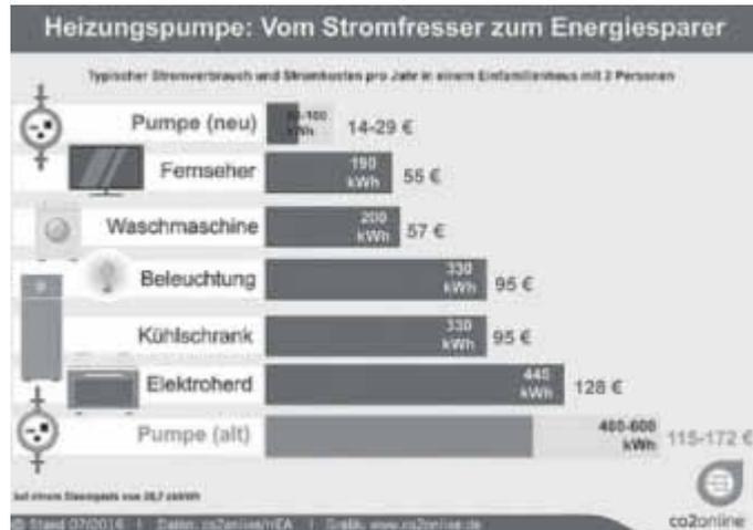
**Tip:** Achten Sie beim Kauf der Pumpe auf besonders energieeffiziente Modelle mit einem Energie-Effizienz-Index (EEI) kleiner gleich 0,20. **Übrigens:** Der EEI ersetzt das Energielabel, das mit den Buchstaben von A bis G die Energieeffizienz eines Gerätes angibt.
